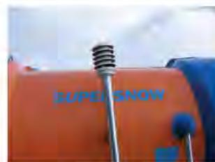
Метеостанция для измерения температуры и влажности
