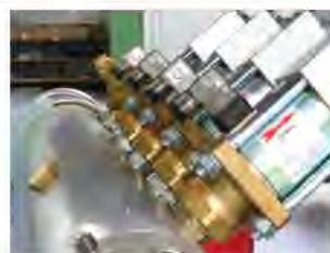
Насосная установка с электромагнитными клапанами
