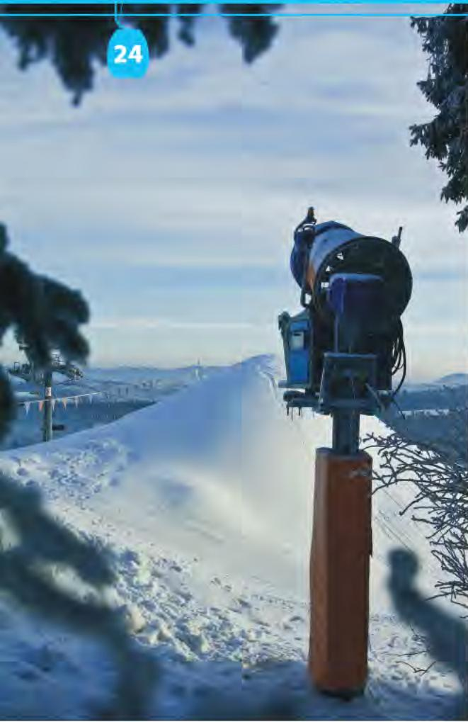
Подъемник Е 400 - это устройство, которое позволяет повысить производительность снежной пушки, увеличить дальность ее действия, и занимать гораздо меньше места на склонах. Благодаря поднятию снежной пушки на 4 метра вверх, время полета распыленных капель воды увеличивается, а это означает, что они имеют больше времени для кристаллизации в воздухе. Этот эффект повышает производительность снегообразования до 40%.
