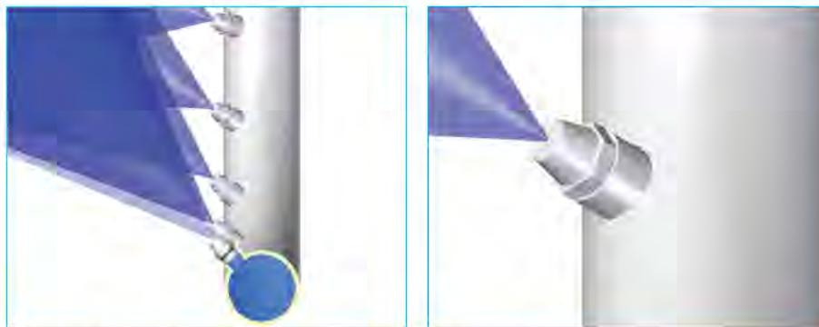
▲ Рисунок 6. Место создания шума в агрегате оснежения
